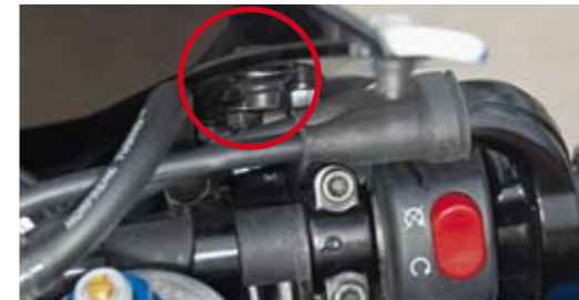
Beim Rangieren steht die Bremspumpe an dem Verkleidungshalter an.
